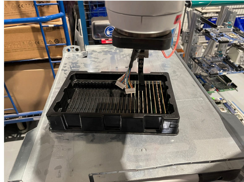
Bras robot pour mettre des barrettes de RAM
